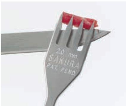
Los tenedores para corte Tissue-Tek Accu-Edge mantienen el tejido en su lugar mientras desliza una cuchilla de disección o bisturí contra las superficies externas del tenedor, lo que da como resultado una sección del espesor deseado entre los dientes.
